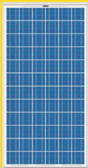
Módulo diseñado conforme a la norma IEC 61.215. Formado por 72 células (156x156 mm) de silicio policristalino, conectadas en serie y configuradas según matriz de 6x12 con tres diodos de by-pass.
